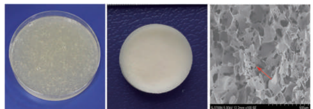
A:冻干前羧甲基壳聚糖与 PRP 的混悬液;B:羧甲基壳聚糖/PRP 冻干后产品;C:冻干后产品的扫描电镜结构图;箭头代表复合支架上负载的血小板
